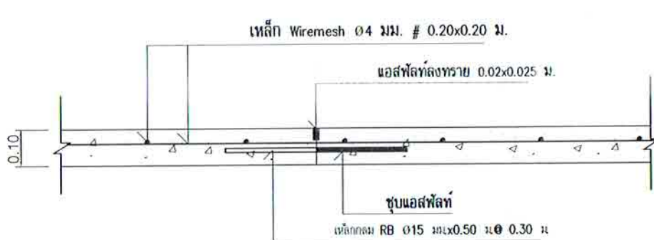
แบบขยาย CONTRACTION JOINT N.T.S
